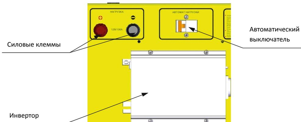
Рисунок №4. Система подключения потребителей силовой цепи 220В.
