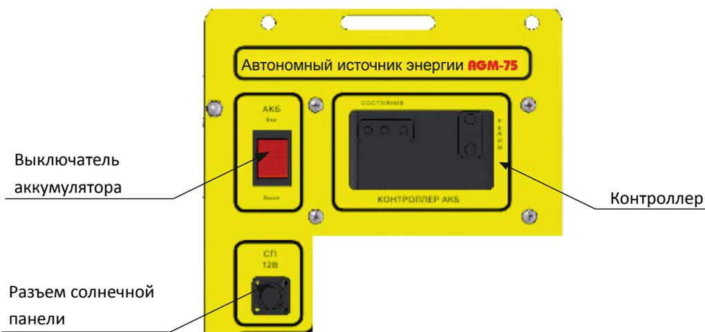
Рисунок №1 Система заряда источника энергии от солнечной панели.
