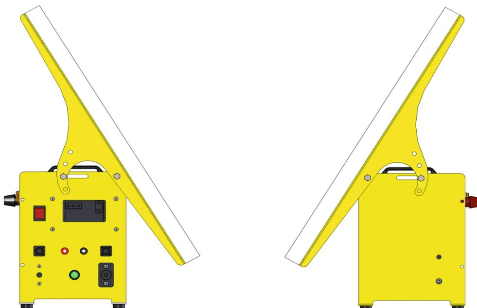
Рисунок №9. Установка солнечной панели на корпусе источника энергии при помощи регулируемого кронштейна
