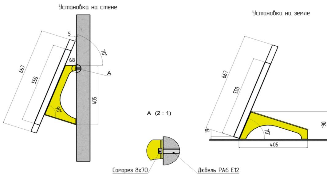
Рисунок № 10. Монтаж солнечной панели на стене и земле.
