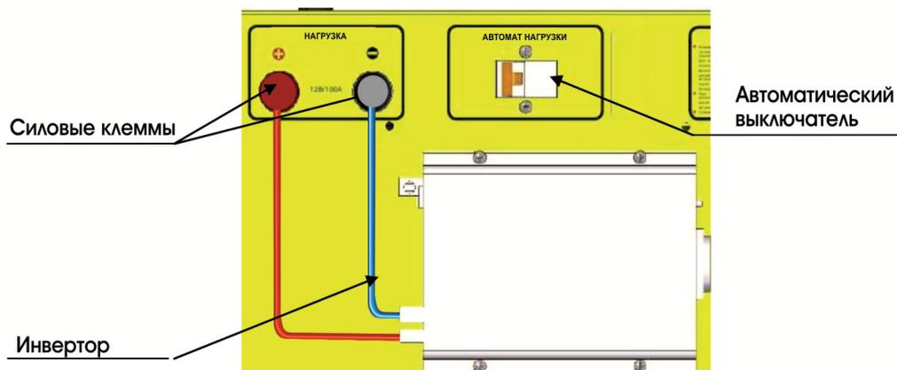
Рисунок №8. Схема подключения инвертора
