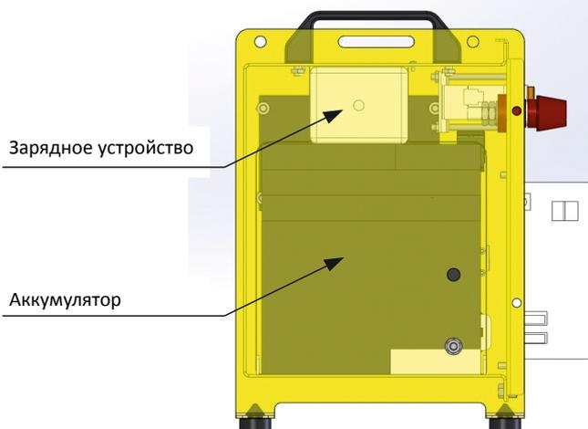
Рисунок 2. Система заряда источника энергии через зарядное устройство.
