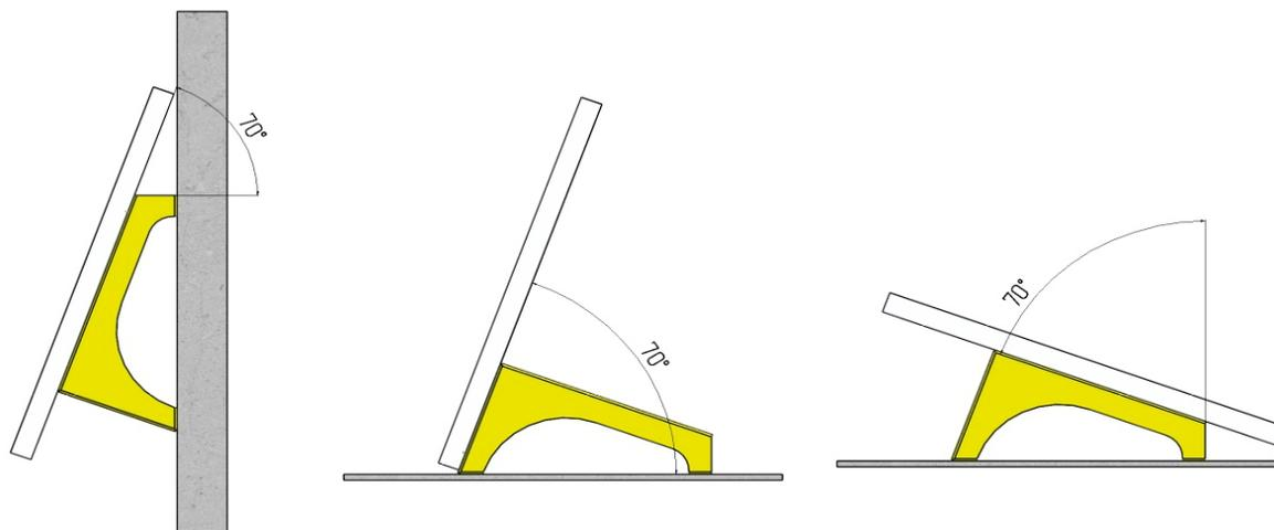
Рисунок №11. Варианты расположения солнечной панели на универсальном кронштейне-опоре.
