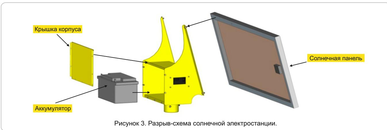
Рисунок 3. Разрыв-схема солнечной электростанции.
