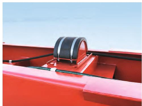
Фиксатор положения кузова от автосамосвала «КАМАЗ».
