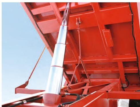
Гидроцилиндр подъема от самосвала «КАМАЗ»
